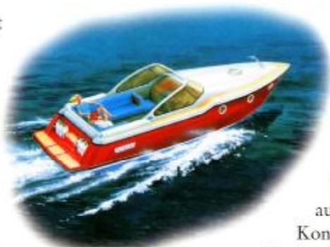
Stehhöhe ausgestattet, die sich in wenigen Minuten im Achterspiegel und an der Oberkante der Windschutzscheibe verstauen läßt. Am Heck befindet sich eine große Badeplattform sowie integrierte Fenderhalter.
