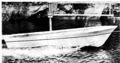
Oben ohne Leisten 18,1 kn, unten mit Leisten 18,1 kn. Bei 18,1 kn zeigt sich, daß der Leistenrumpf mit deutlich steilerem Gleitwinkel läuft.
