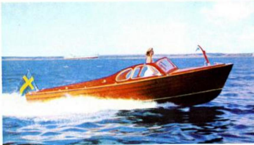
► Säval VINDÖ som SOLÖ är försedda med världsrekord-motorn Volvo-Penta BB 70 som ger hela 65 hk vid 4000 r/m... bensindriven och försedd med fullförgasare, bränslepump, oljerenare, oljekylare, startmotor, generator, batteri, vattenkyld avguskrök, gummiupphängning samt reduktionsbackslag med utväxling 1,9:1.
