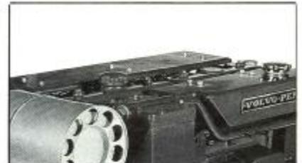
*Eine praktische Sache ist die Schutzplatte über den Einspritzleitungen.*
