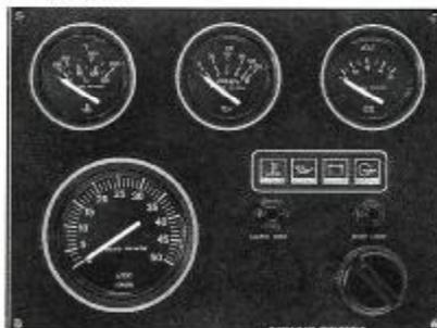
Die Instrumententafel hat klar verständliche Iso-Symbole für Kühlwassertemperatur, Öldruck und Ladekontrolle. Doppelverglasung der Instrumente, um Kondensation zu verhindern. Schlüsselschalter mit Start- und Stoppfunktion und Anlaßwiederholersperre.
