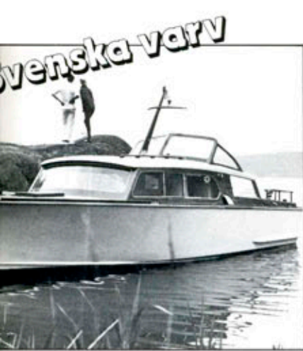
Storö I, lik 34:an men betydligt mindre och utan akterruff. Motorutrustning två stycken Volvo B16 bensinmotorer.
