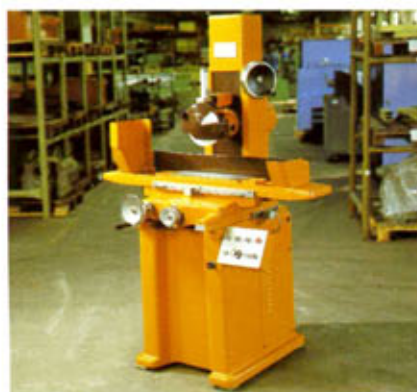
STOREBRO MPS 450 Planslipmaskin med arbetsbord 450×150 mm.
