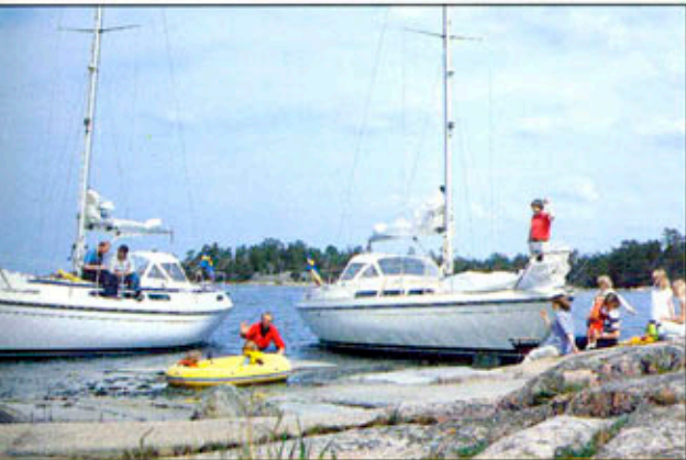
Det fenkölade, Carterritade skrovet till 33:an är ett utpräglat segelbåtsskrov även om överbyggnad och inredningskomfort är motorseglarbetonad.
