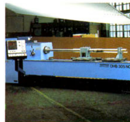
STOREBRO DHB 305 NC Storebros långhålsbormaskiner i 3 storlekar, borrhåda ø5-300 mm.
